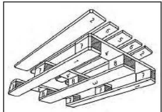
La normativa DIN13698 stabilisce le caratteristiche del bancale "EPAL".
