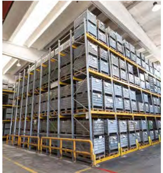
Magazzino FIFO per carichi molto pesanti / FIFO system for high weight pallets
