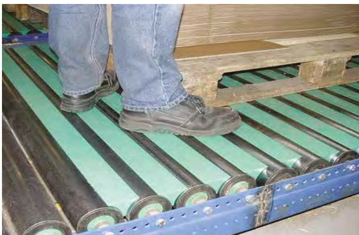
Elementi mobili per camminare sulle rulliere a terra Safety bars for walk on floor roller conveyors
