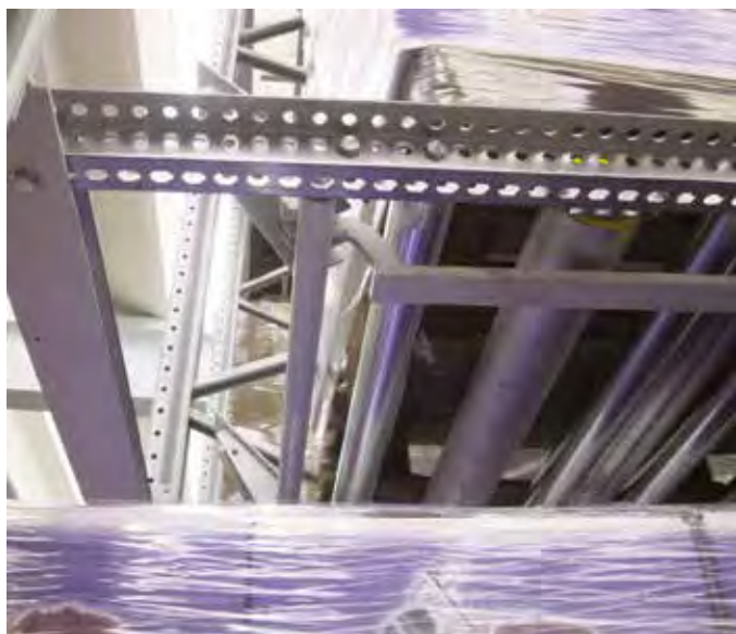
Modulo uscita con angolare e gruppo di separazione Unloading section with L beam and pallets separator
