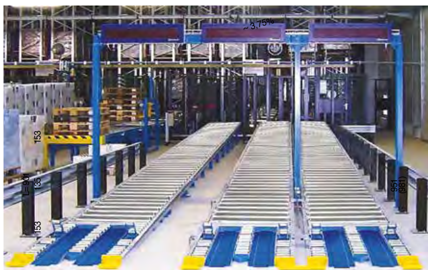
2.17 Stazione sopraelevata per carrelli elevatori a mano
